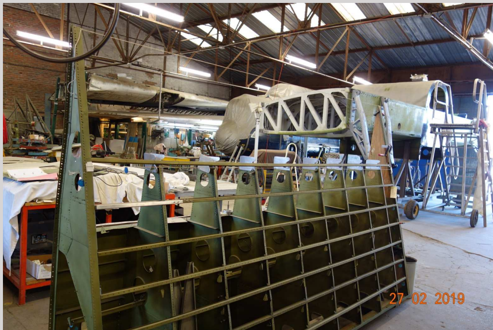
Structure du LANCASTER WU21 © les Ailes Anciennes
