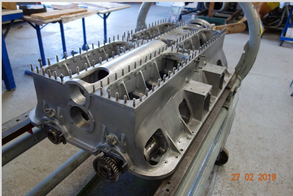
Bloc moteur Bugatti en cours de remontage © les Ailes Anciennes
